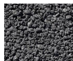
Enrobé bitumeux drainant
